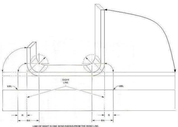
LINE OF SIGHT IS ONE BEND RADIUS FROM THE BEND LINE, WHICH FITS UNDER THE NOSE OF THE BRAKE.
