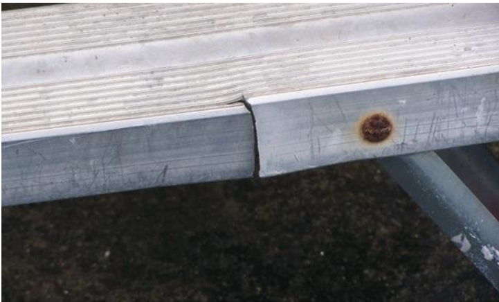
(B) CRACKED STEPLADDER
